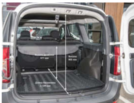
Рисунок 5. Размеры багажника «Лада Ларгус»
